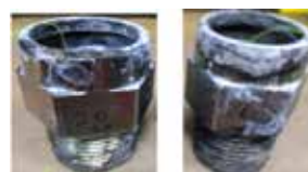
Campioni dopo 400 ore testati secondo ISO 9227 NSS
