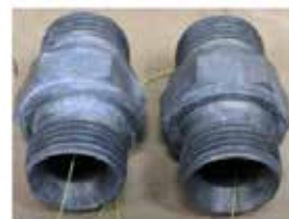
Campioni dopo 720 ore testati secondo ISO 9227 NSS
