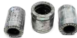
Campioni dopo 720 ore, testati secondo ISO 9227 NSS
